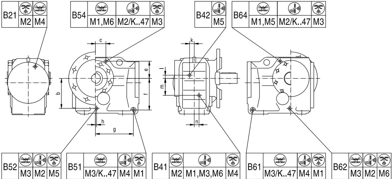
\* Verschlussbohrung befindet sich antriebsseitig (z.B. Motorflansch, Adapter)
