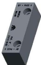
Перепускной элемент имеет те же размеры, что и дозатор, но без внутреннего поршня, поэтому не осуществляет дозирование. Его функцией является создание резервной позиции, где затем можно установить дозирующий клапан для увеличения количества выходов.
